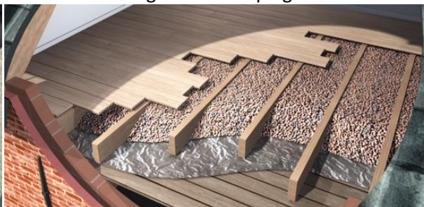
Aanvullingen in verdiepingsvloeren:
